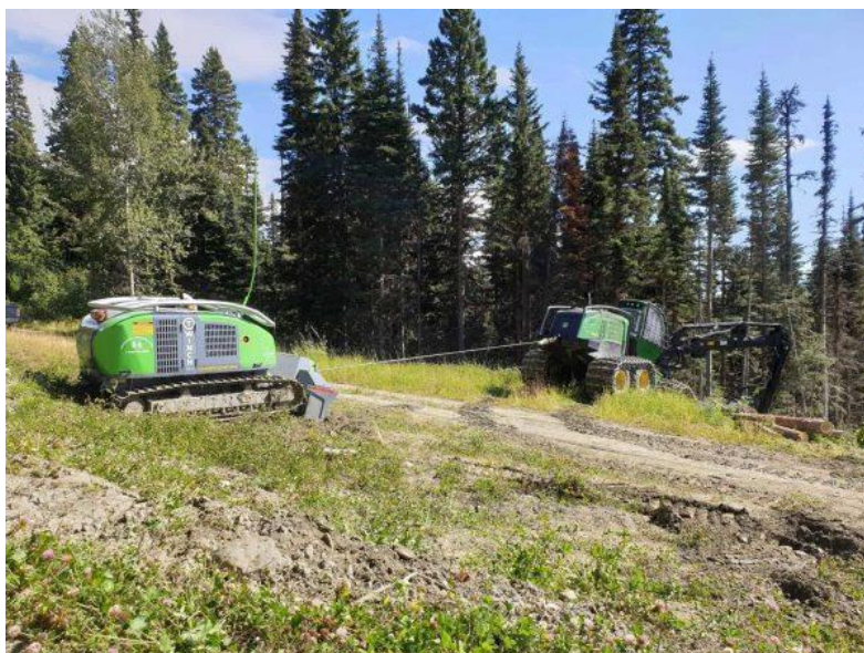
図 IV-3 ウインチで傾斜地での重機の安全性を確保する機械の例
